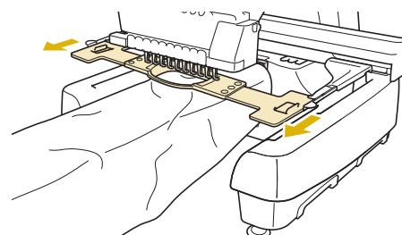
**2** Tenez la poignée au niveau de la partie inférieure de la table pour cadre à broder pour la broderie tubulaire et remettez la table dans sa position d'origine.
